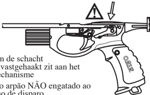
NL Positie van de schacht die NIET vastgehaakt zit aan het trekkermechanisme
