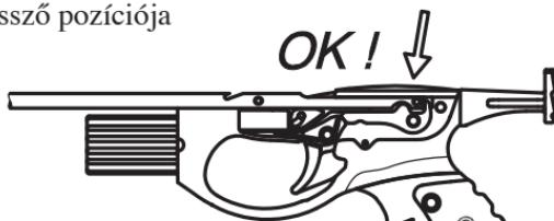
NL De blokkeringsspen voegt zich in de inkeping van de schacht door deze te haken aan het trekkermechanisme
